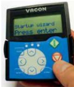
中文图形化面板，显示，参数备份复制，快速设定传动
