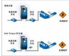
Safe Torque Off(STO) 功能适用于所有 VACON® NXP 变频器。该功能可有效防止驱动器向电机轴输出转矩，从而避免电机意外起动
